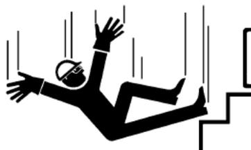
В целях обеспечения безопасности, лицом к машине, твердо ухватиться за поручнем и надежно наступать на ступень (включая гусеничный башмак) в трех точках (два нога и одна рука или две руки и один нога).
