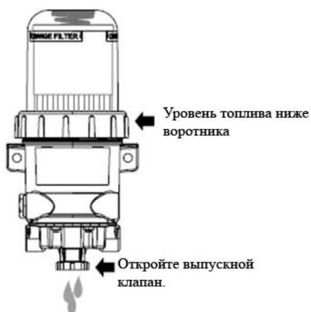
3. Используйте ключ для металлической манжеты, чтобы снять манжету. Снимите использованное уплотнительное кольцо верхней крышки, снимите прозрачную верхнюю крышку и использованный фильтрующий элемент. Утилизируйте использованный фильтрующий элемент и уплотнительное кольцо надлежащим образом.
