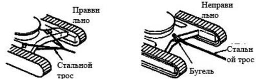
Избегать перетирания стального кабеля, между рамой шасси и стальным кабелем размещать защитные материалы.
