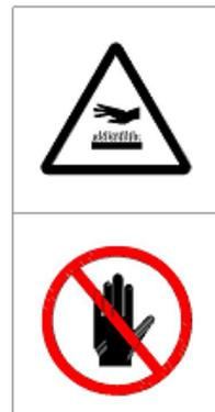
(14) Предупреждающий знак защиты от ожогов охлаждающей жидкостью высокой температурой и гидравлическим маслом
