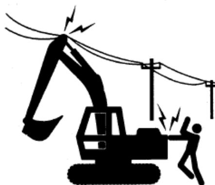
b. При работе близко высоковольтных электропроводов, нельзя передвигать любые части экскаватора или нагрузки в расстояние 3 метра плюс 2 раза длины линейного изолятора от электропроводов .
