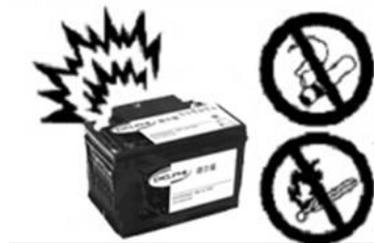
Существует риск искрения при операции аккумуляторов. Поверните ключ зажигания в положение «ВЫКЛ.» и выполните следующие шаги:
